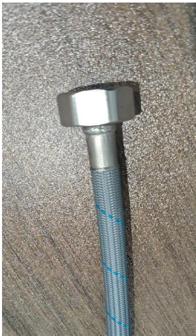
● Rivestimento ESTERNO dei Tubi dell'impianto idrico sui prodotti MEDIOCRI □ INOX 201
