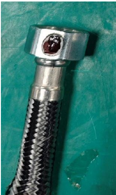
● Rivestimento ESTERNO dei Tubi dell'impianto idrico sui prodotti BASICI □ INOX 201
